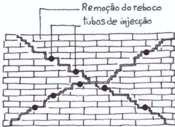
Fig. 9.14. a | Disposição dos furos para selagem das fendas
