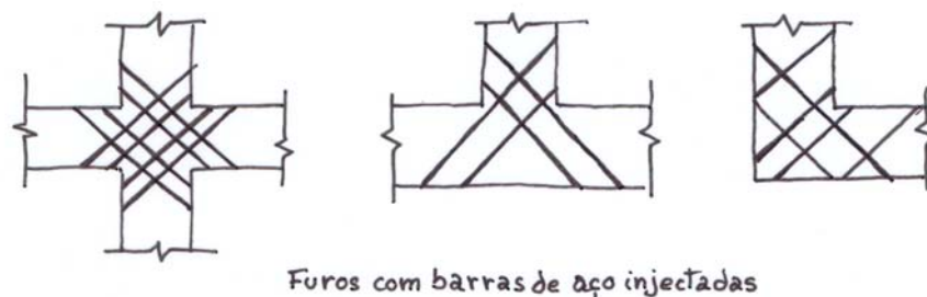
Fig. 9.40 | Esquemas de reforços de ligações entre paredes, com a introdução de tirantes curtos
