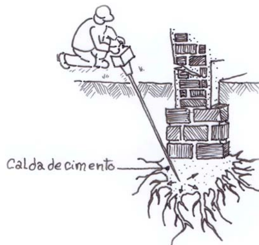
Fig. 9.8 | Esquema de injeção de calda de cimento para consolidação da camada de assentamento
